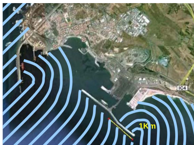
Fig. 5. A direcção da ondulação roda após passar junto à cabeça dos molhes do Porto de Sines
